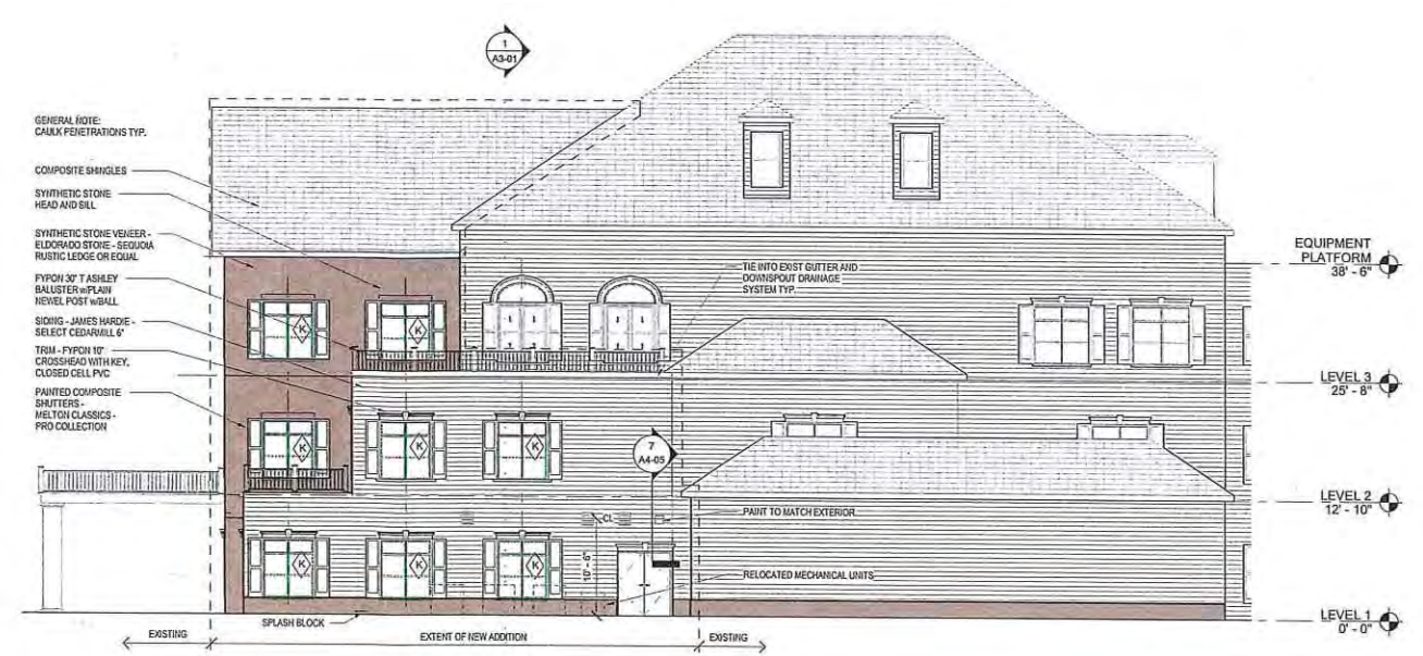
2 EAST EXTERIOR ELEVATION SCALE: 1/8" = 1'-0"
